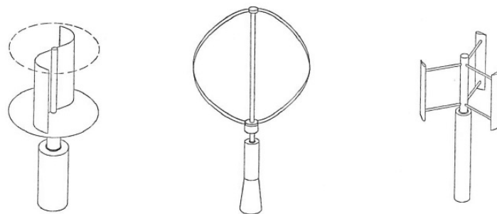
図1 種々の垂直軸風車（左から S 字風車、ダリウス風車、垂直軸直線翼風車）
